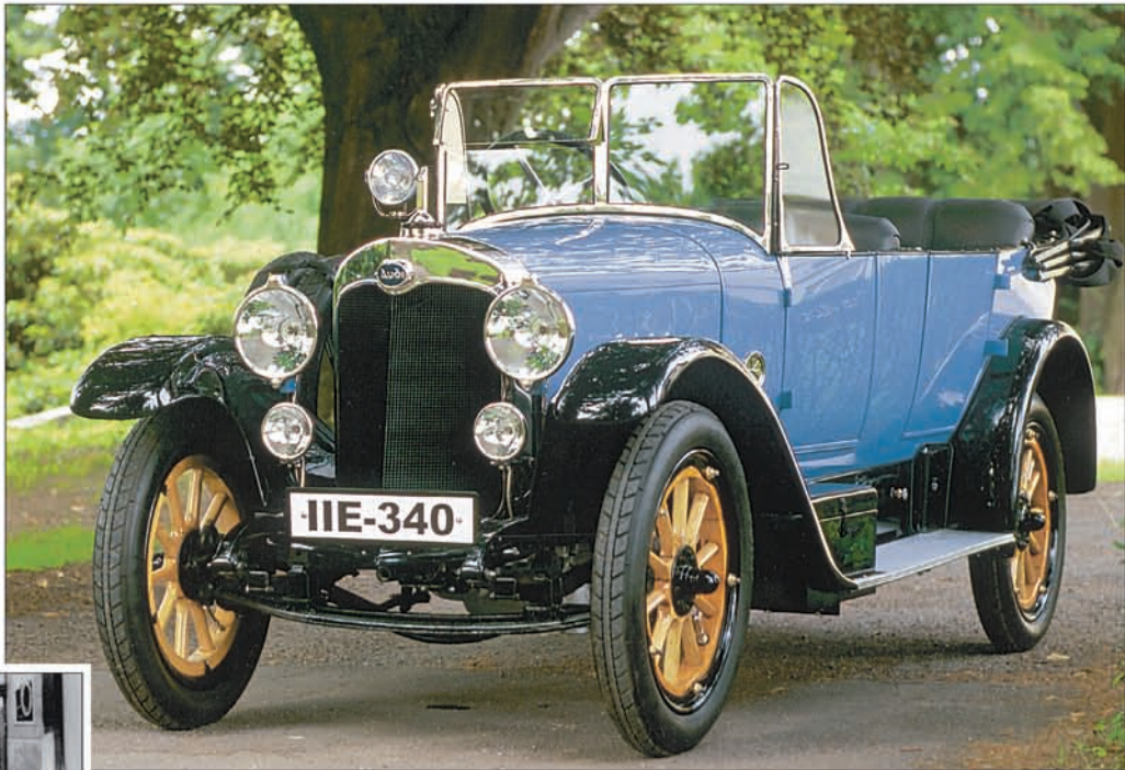
Ein Traum in Blau: 1923 wurde der Audi G erstmals produziert. Ausgestattet mit einem 4-Zylinder-Motor mit 22 PS war er eine „Rakete“ auf den Straßen.
